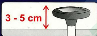
Uprostřed oblasti, z které chcete vypudit krty a ostatní hlodavce, vykopějte díru do země a umístěte do ní zařízení tak, aby se panel nacházel 3 - 5 cm nad úrovní terénu. Nikdy zařízení neumísťujte do nezkypřené zeminy. Hrozí jeho poškození. /
